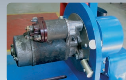
Крепление стартера за фланец
